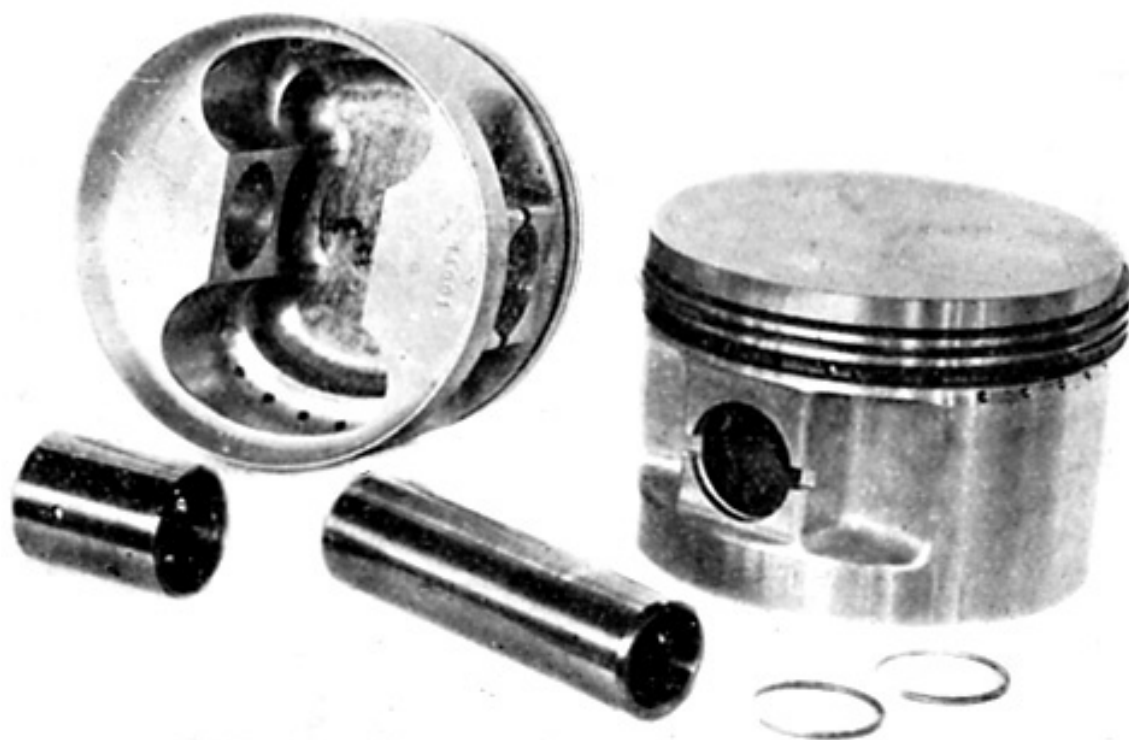
図Ⅲ-6 三菱モンゴース発動機のピストンとピストンピン浮動ブシュ
