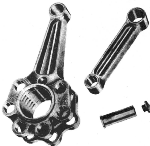
図IV-10 Hispano-Suiza 14AA 発動機の連桿
