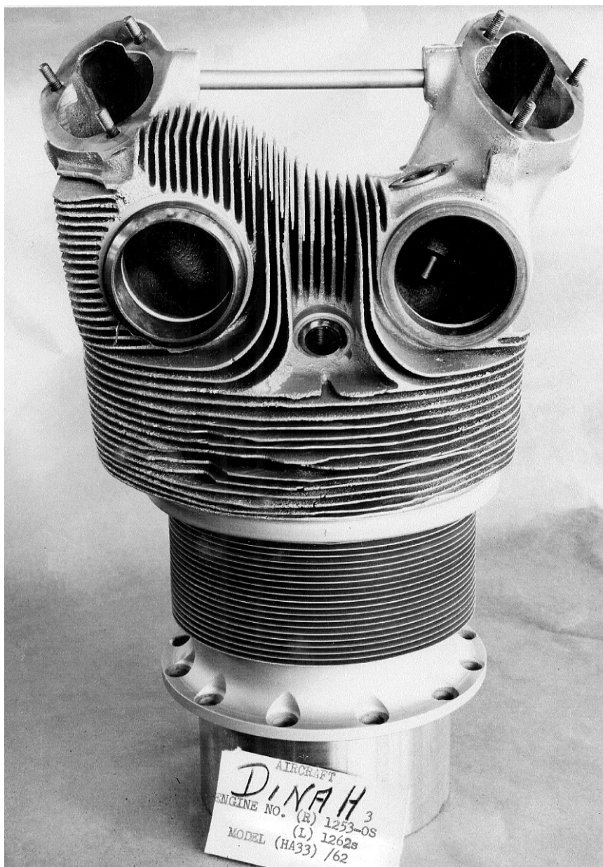
図V-134 金星 62 型の気筒
