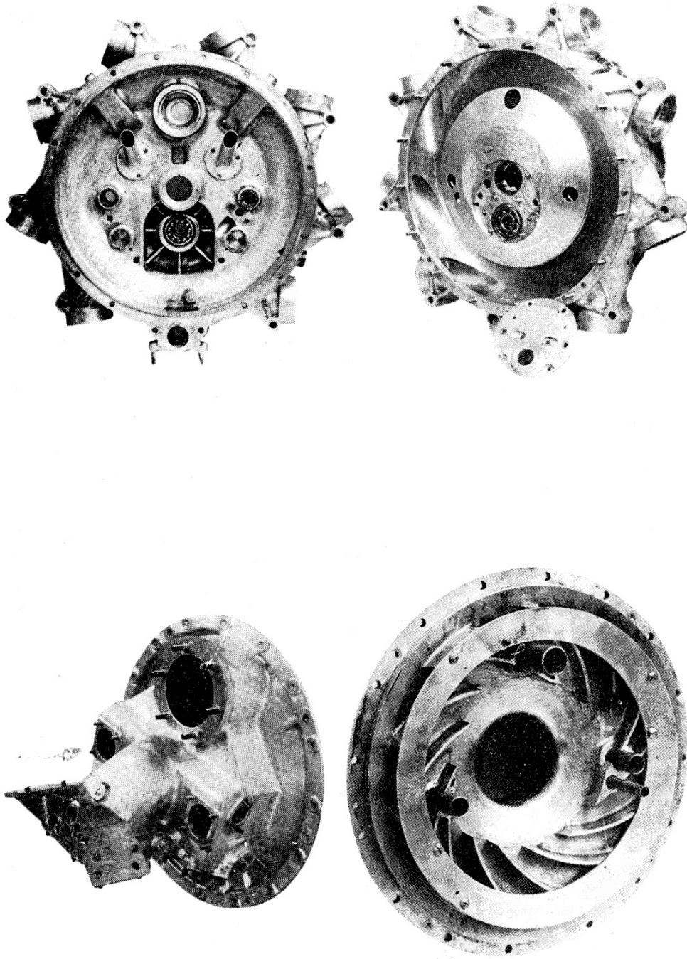
図III-28 92式400馬力発動機の翼車筐と後蓋
