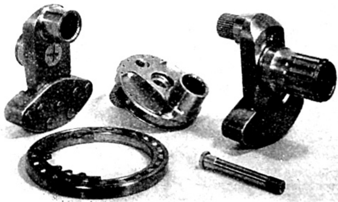
図V-117 金星 40 型のクランク軸回り
