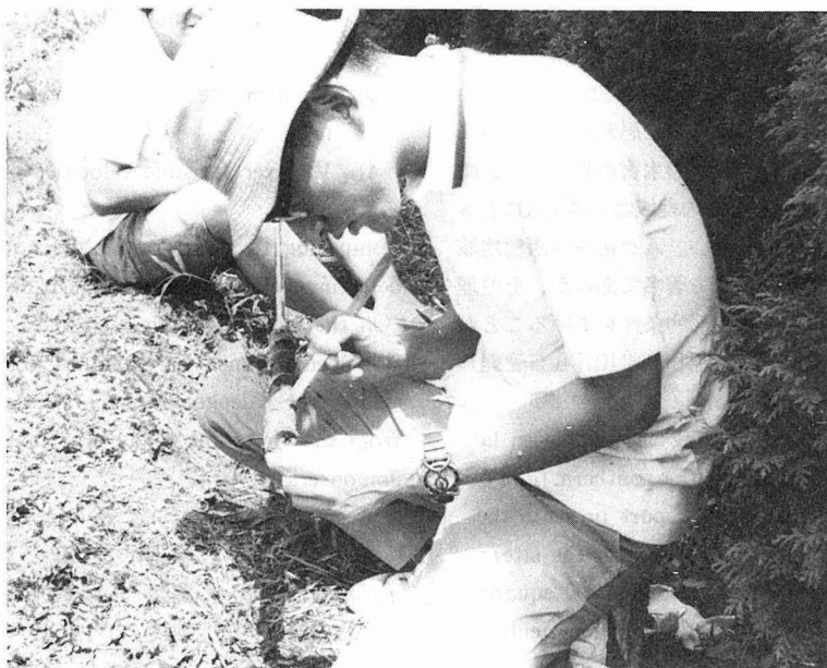
写真1 BP-13におけるハンドオーガーボーリング
