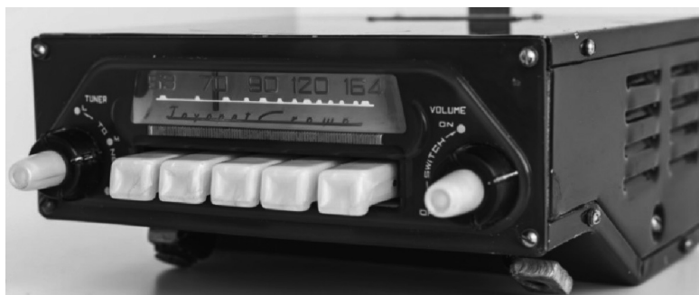
図表1 神戸工業製 初代クラウン用 オール真空管型カーラジオ本体
