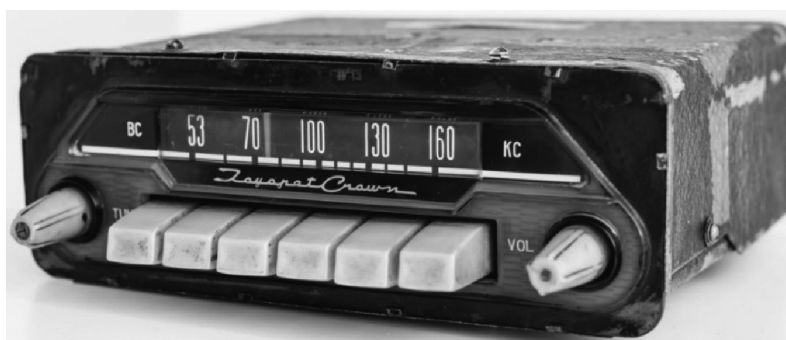
図表3 神戸工業製 初代クラウン用 オールトランジスタ型カーラジオ（前期型）本体
