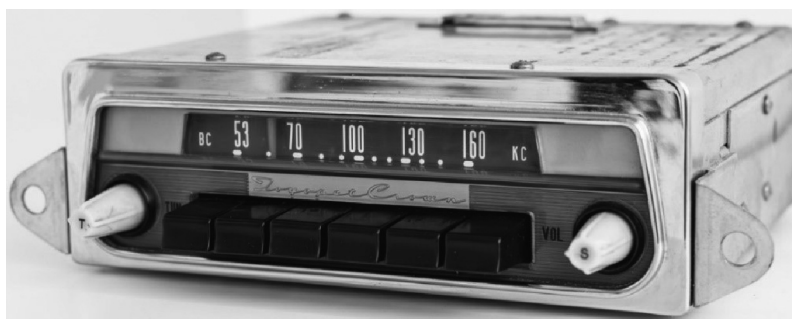
図表4 神戸工業製 初代クラウン用 オールトランジスタ型カーラジオ（後期型）本体 95)
