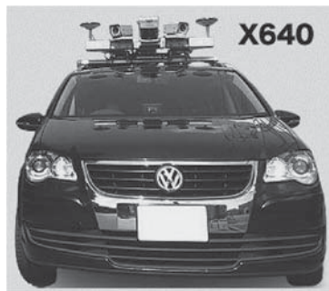
図18. アイサンテクノロジー社のMMS（モバイル・マッピング・システム）
