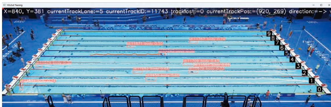
図3：認識システムによる泳者位置と軌跡同定の様子
