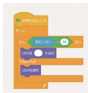
図 11 光センサーでライトを光らせるプログラム
