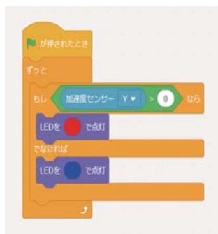
図 10 加速度センサーでライトを光らせるプログラム
